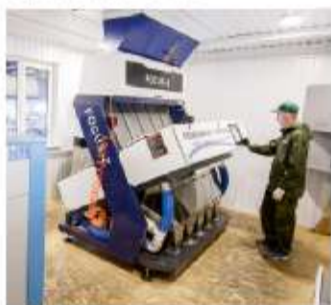
Работают две линии очистки семян с использованием оптических сортировочных, которые позволяют добиваться 99,9% чистоты продукта.
